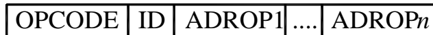
Fig. 22 – Formatul unei instructiuni in care este specificat modul de adresare al memoriei (campul ID)
